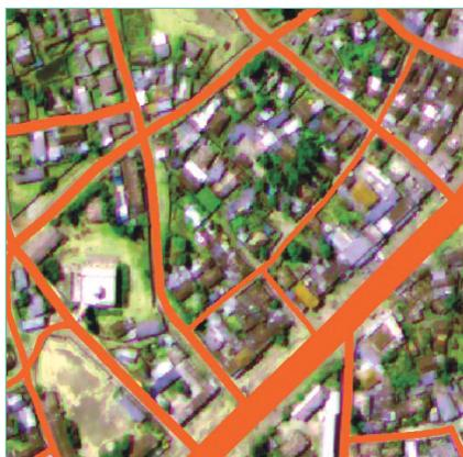
Le tracé de la voirie, en respectant une largeur standard différente pour les voies principales et secondaires, permet de figurer en négatif le contour des îlots urbains. Ensuite, il suffit d'inverser le remplissage zonal pour obtenir la forme des îlots.
